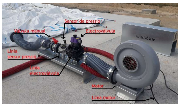
Figura 14. Elements que conformen el sistema d'inflat
